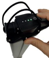
**Support moteur :** à fixer sur le tableau arrière de votre embarcation grâce aux vis de pression. Venez ensuite glisser votre moteur dans le support moteur pour le fixer et baissez la poignée principale pour verrouiller le moteur. Avant d'effectuer une marche arrière, assurez-vous que la béquille soit repoussée vers l'arrière.
